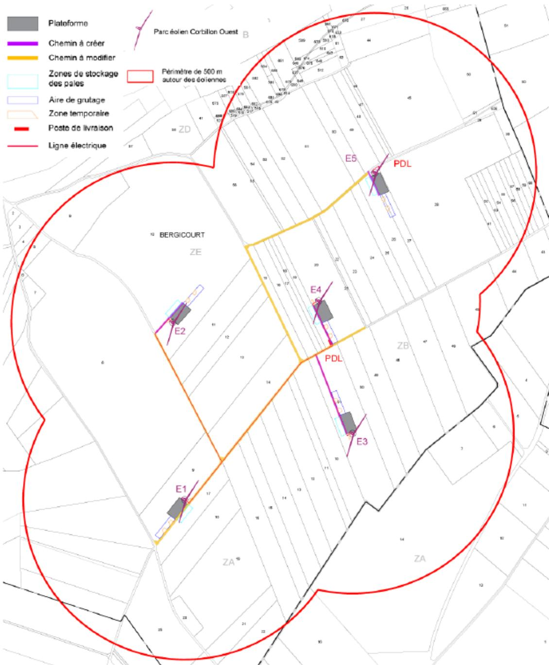
Figure 15 - Chemin à créer et à modifier pour le parc éolien de Corbillon-Ouest – Source : Ventelys Energies Partagées
